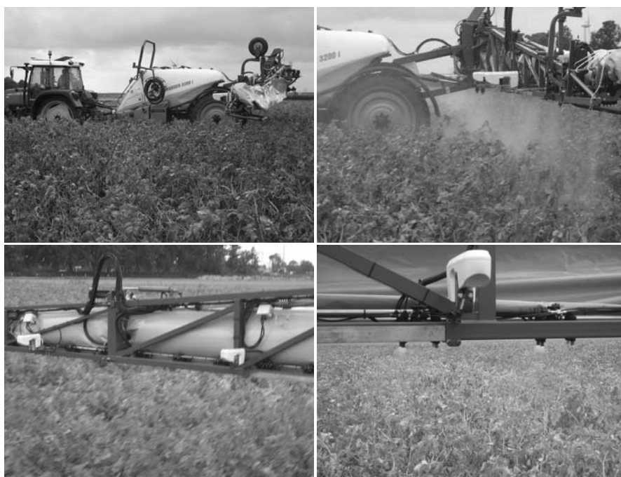
Figuur 3. Greenseeker-sensoren op SensiSpray. Op iedere sectie van de spuitboom staat één sensor die de dosering van die sectie aanstuurt.
